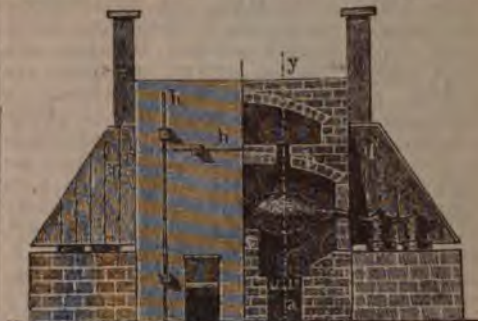
Фиг. 2. Печь для добыванія фосфора.
